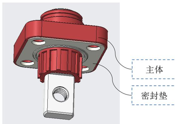
将 4 颗螺栓依次安装在安装面板上，推荐的安装参数如下。
